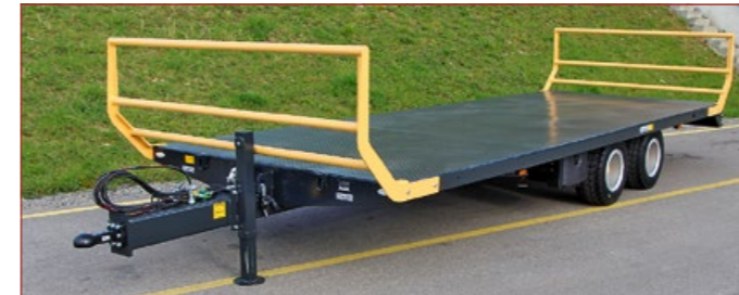
Plattformanhänger ZATA mit kippbarer Brücke bis 20'000kg Gesamtgewicht
